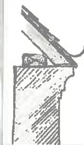
Gouttières havraises sur corniche en briques ou en pierres.
